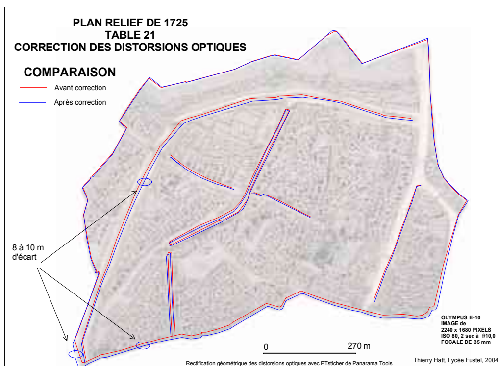
Figure 8, impact des corrections des distorsions optiques liées à l'objectif
