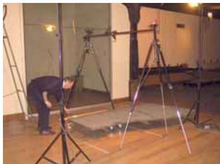
Figure 9, échafaudage pour la prise des images zénithales
