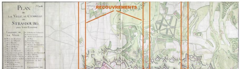
Géo-rectification "manuelle" de l'image sur fond repéré de l'IGN 1980 avec Photoshop 6.0
